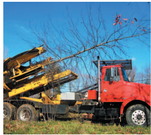
그림 2. 굴취, 운반, 이식까지 해결하는 최근 수목이식 장비
